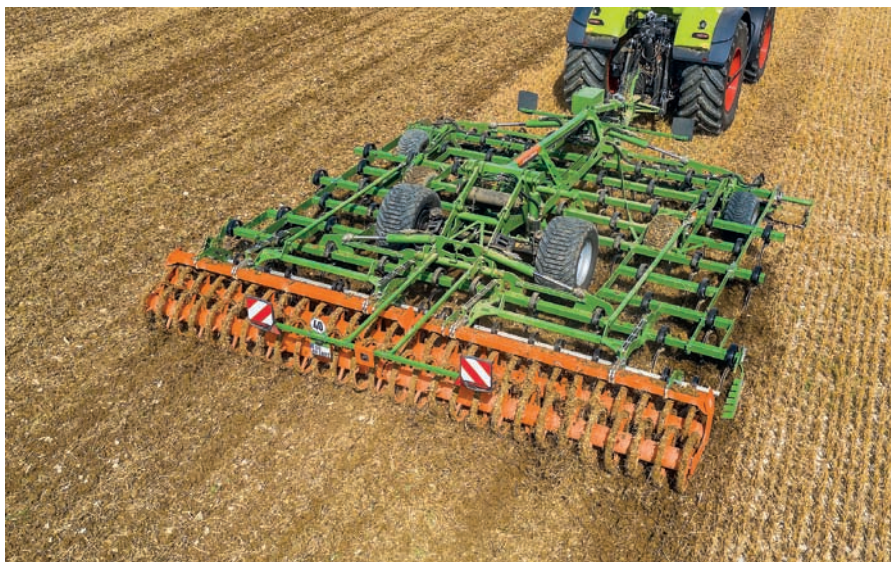
Kultywator Cobra-2TX to narzędzie 6-belkowe z zębami sprężystymi, które mogą być zakończone gęsiostópkami o szerokości 220 mm lub redliczkami wąskimi 50-milimetrowymi.
