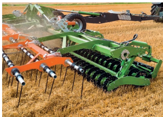
Kombinacja TopCut z wałem nożowym, dwoma rzędami talerzy falistych i trzema rzędami palców sprężystych.
