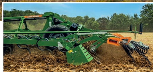
Ostatnim elementem roboczym kultywatora Cobra-2TX może być jeden z 9 rodzajów wałów Amazone (w wersji podwójnej lub pojedynczej) lub 2 rzędy zębów sprężystych.
