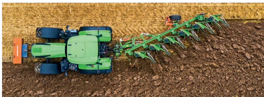
Pługi Amazone Teres 300 budowane są na bazie stalowej prostokątnej ramy o wymiarach 150x150x8,8 mm.
