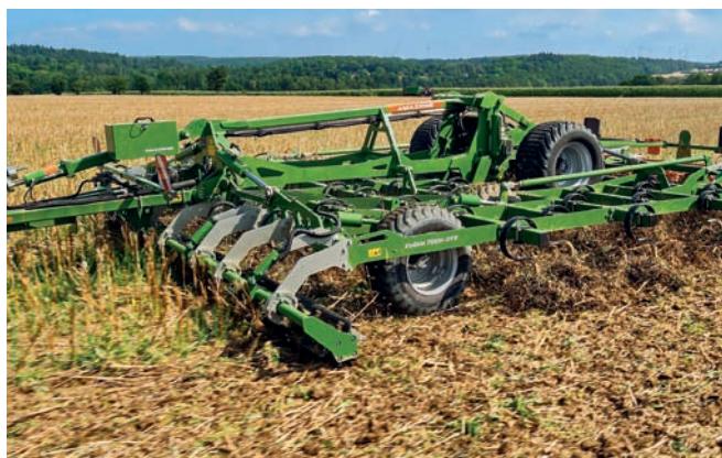
Pierwszym elementem roboczym kultywatora Cobra-2TX może być wał nożowy.
