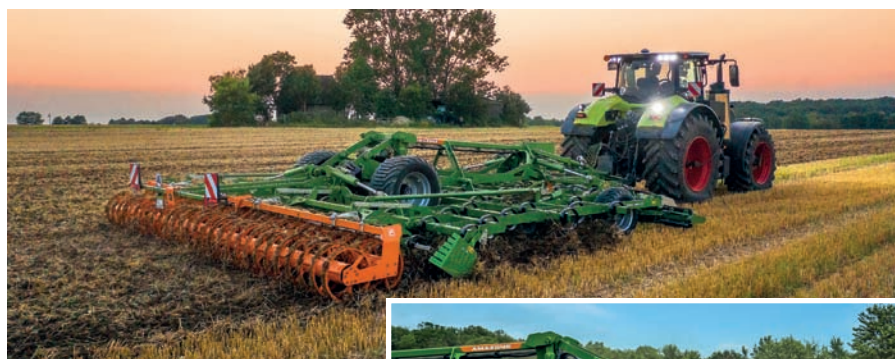
Ostatnim elementem roboczym kultywatora Cobra-2TX może być jeden z 9 rodzajów wałów Amazone (w wersji podwójnej lub pojedynczej) lub 2 rzędy zębów sprężystych.
