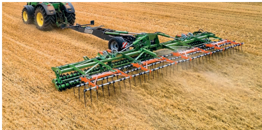
Kombinacja TopCut oparta na dwóch wałach kolczastych i trzech rzędach palców sprężystych.
