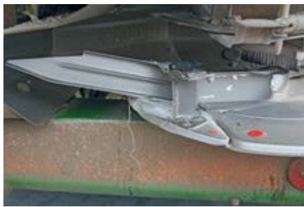
Po wysianiu ponad 1500 ton nawozów został wymieniony komplet łopatek rozsiewających.
