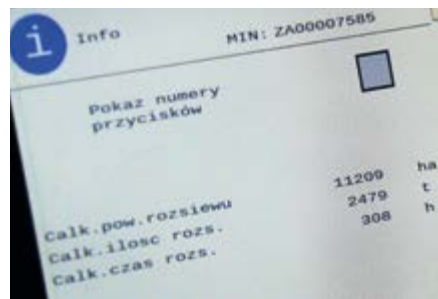
W dniu naszej wizyty rozsiewacz wskazywał przepracowanie 11209 ha i wysiew 2479 ton nawozu.
