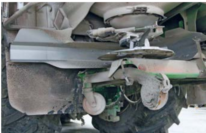
Karol Lewandowski chwali Amazone za rozwiązanie dwóch par kótek transportowych rozsiewacza. Wystarczy mocno nacisnąć ich mechanizm nogą i same się rozkładają lub składają.
