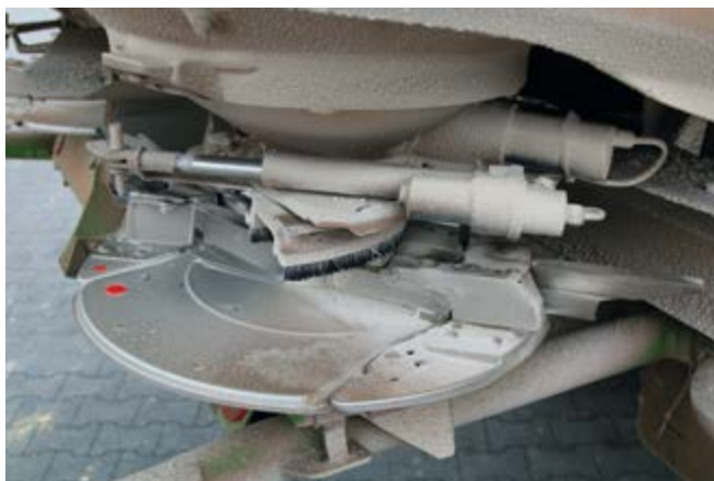
Tarcze rozsiewające Amazone ZA-TS Hydro uzyskują napęd od hydrauliki ciągnika, ale zmiany rodzaju i dawki rozsiewu odbywają się za pomocą silniczków elektrycznych.
