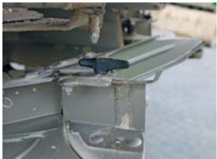
W przypadku rozsiewu granicznego następuje elektryczne przestawianie łopatek rozsiewających. Czasami trzeba jednak wyjść z ciągnika i zmienić długość widocznego na zdjęciu zakończenia krótkiej łopatki rozsiewającej.
