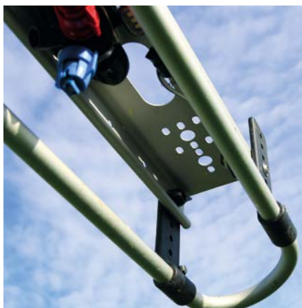
Na końcu belki polowej jest miejsce na dotożenie rozpylacza do oprysków granic pól.
