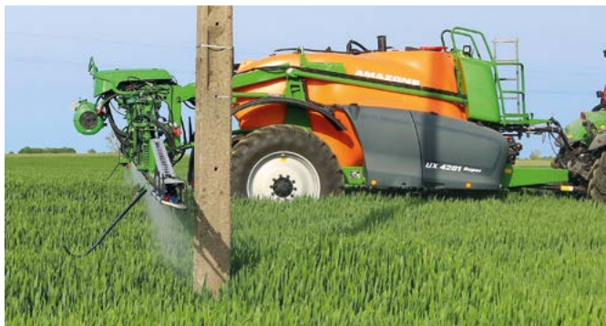
Omijanie słupów ułatwia złożenie/rozłożenie tylko skrajnego segmentu belki.
