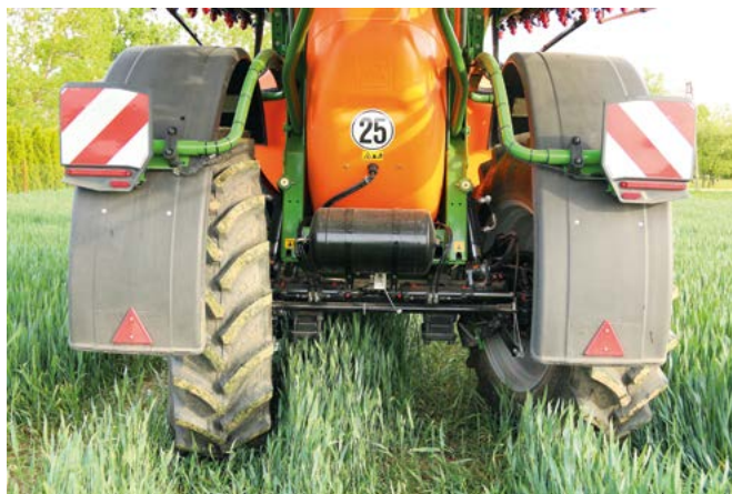
Hydrauliczno-pneumatyczne zawieszenie osi połączone z jej funkcją skrętną AutoTrail (do 28°) wspomaga także stabilność belki polowej opryskiwacza.
