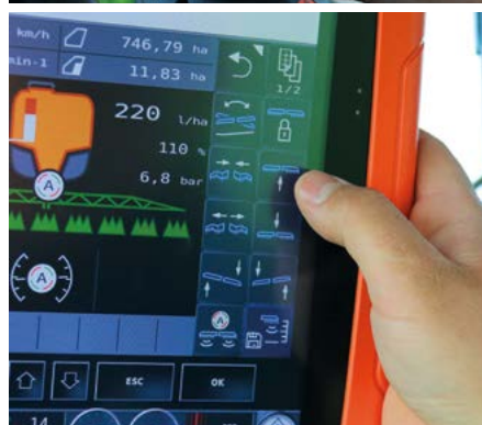
Artur Książek hydraulikę belki polowej może obsługiwać z dżojstika ciągnika Fendt lub terminala AmaPad.
