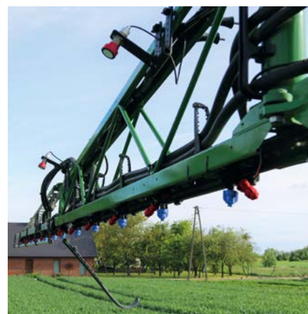
W opryskiwaczu pracującym w Wudzynku na każdej z połówek belki Super-L zamontowane są po dwa czujniki ultradźwiękowe systemu DistanceControl.
