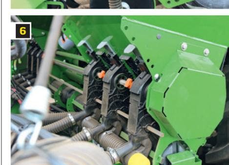
mit dem Hauptrahmen verbunden. Bei der Precea gibt es die Möglichkeit, zwischen zwei unterschiedlichen Schardrucksystemen zu wählen. Unsere Maschine war mit der mechanischen Variante ausgestattet, sodass wir für den Schardruck bis zu 220 kg (inklusive Eigengewicht der Reihe von 120 kg) über eine Spiralfeder einstellen konnten. Dies muss man an jedem Säaggregat manuell vornehmen.
