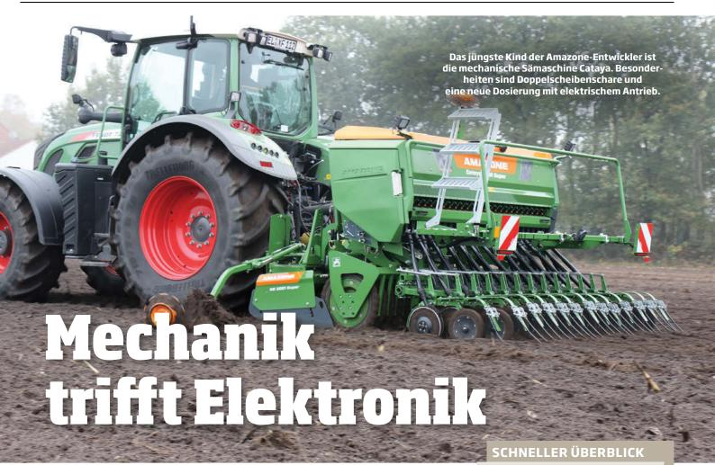
Feldprobe Die mechanischen Sämaschinen wie die AD und D9 von Amazone sind eine feste Größe. Mit der Catava ergänzt Amazone das Programm nach oben mit innovativer Dosiertechnik, Doppelscheibenscharen und Matrixwalze.
