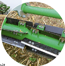
Die vorlaufende Messerwalze ist neu. Die versetzte Messeranordnung soll das Zusetzen vermeiden.
