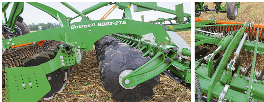
Zur Tiefenverstellung wird der gesamte Balken verdreht, das bringt Platz für Boden und Erntereste. Auf Wunsch geht das hydraulisch.
