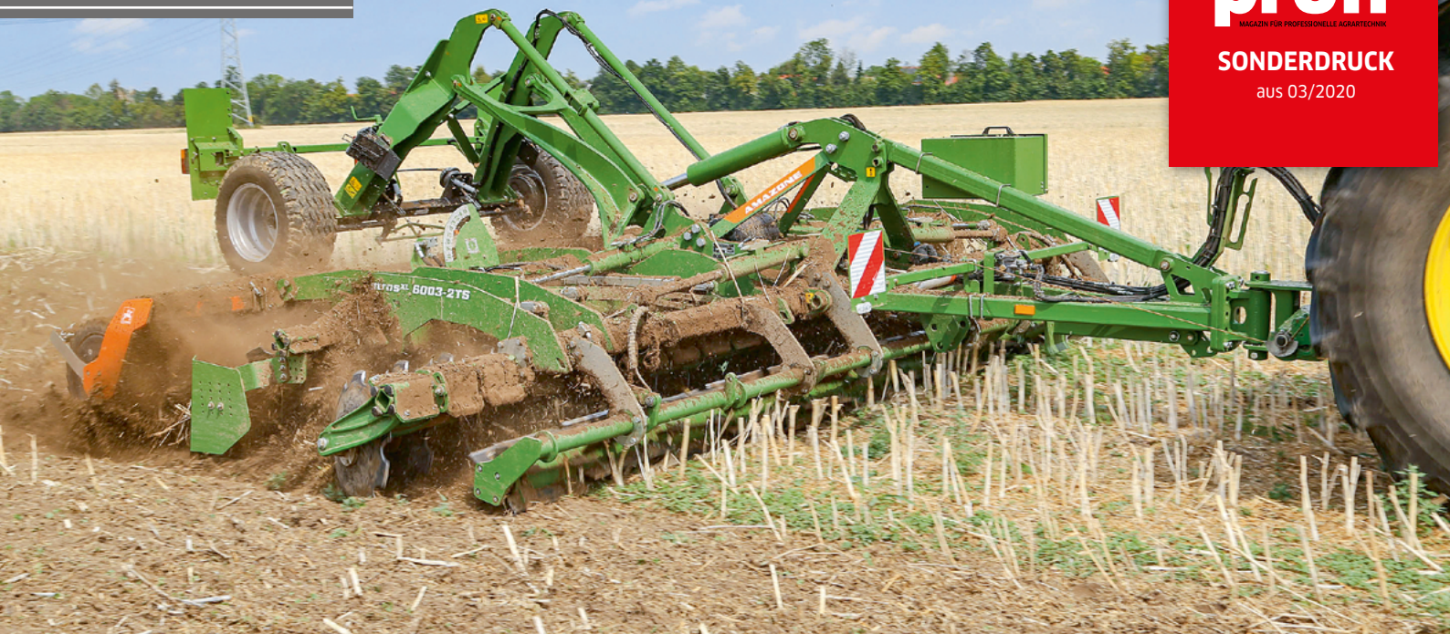
Die CatrosXL eignet sich für die flache bis mitteltiefe Bodenbearbeitung. Lieferbar ist ab sofort auch eine vorlaufende Messerwalze. Fotos: Brüse
