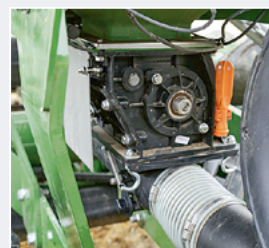
Gebläse und Dosiereinrichtung stammen von den Cirrus-Sämaschinen.
