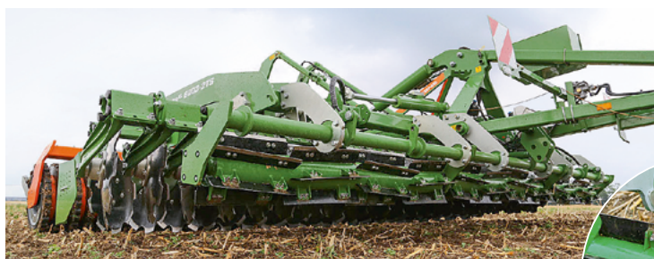
Die vorlaufende Messerwalze ist neu. Die versetzte Messeranordnung soll das Zusetzen vermeiden.
