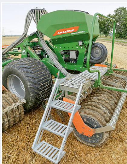
Die GreenDrill 501 hat einen 500-l-Behälter und einen stabilen und sicheren Beladesteg.
