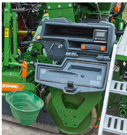
Das SmartCenter mit komplettem Zubehör sorgt für viel Komfort beim Abdrehen.
