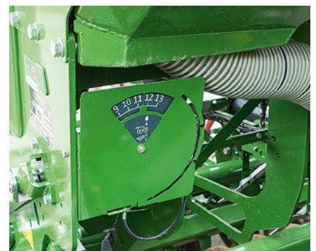
Die bisherige Bowdenzug-Mechanik zur Schardruck-Anzeige war zu störanfällig.
