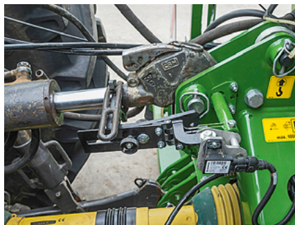
Der Sensor am Oberlenker sorgt für das Ein-/ Ausschalten der Drille am Vorgewende und für das Weiterschalten der Fahrgassen.
