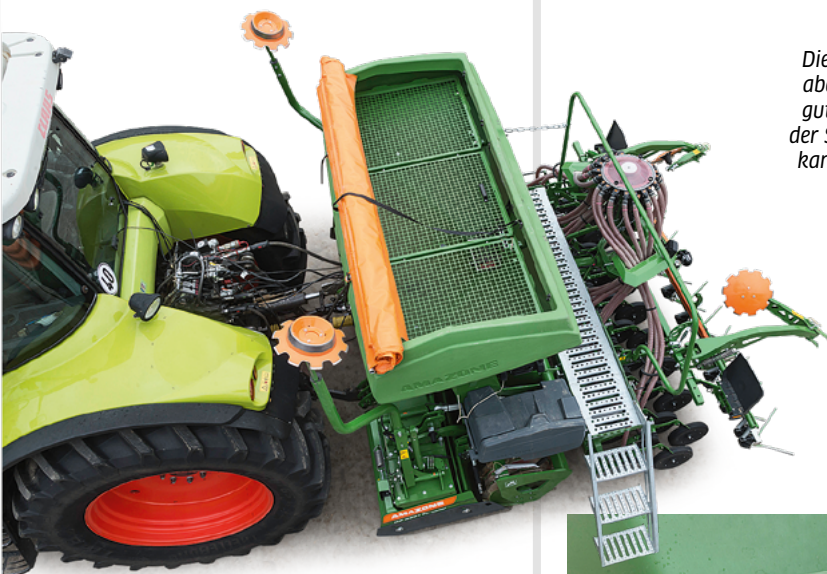
Der Sensor am Oberlenker sorgt für das Ein-/ Ausschalten der Drille am Vorgewende und für das Weiterschalten der Fahrgassen.
