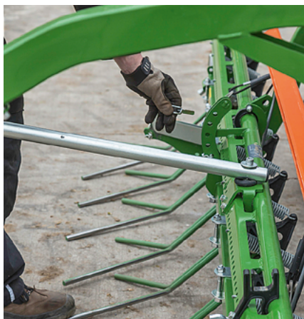
Der Exaktstriegel S mit 15 mm (!) starken Zinken lässt sich einfach einstellen.
