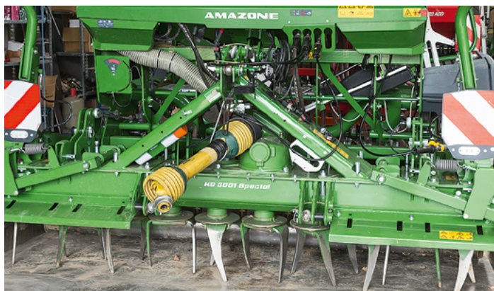
In unserem Praxistest war die Centaya auf dem Kreiselgrubber KG 3001 Special mit Trapezringwalze aufgebaut.
