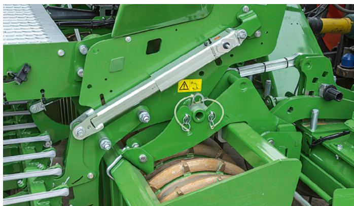
„Quick-Link Schnellwechselsystem“ nennt Amazone die Kopplung zwischen Kreiselgrubber und Aufbaudrille. Die beiden Aufnahmen auf dem Rahmen der Packerwalze sowie der Oberlenker lassen eine schnelle Trennung von Bodenbearbeitung und Drilltechnik zu.
