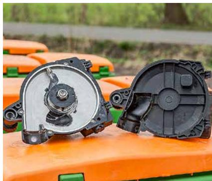
Links der Gehäusedeckel mit Portionierflügel, rechts eine Alternative zur Düngerablege im Band.
