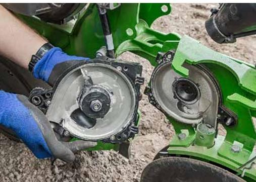
Im Gehäusedeckel treibt ein Elektromotor den Portionierflügel an, der synchron zum Saatkorn Dünger in das Schar schießt.
