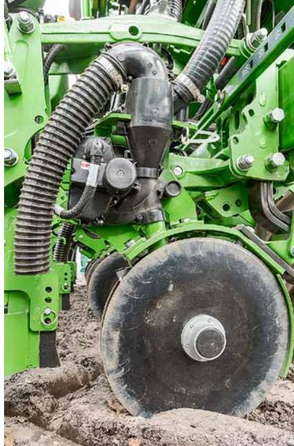
Zwischen dem Luftabscheider und dem Doppelscheibenschar kommt für Fertispot ein zusätzlicher Portionierer hinzu.
