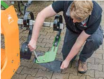
Das geht besser: Für die Randwerkzeuge benötigt man einen Schraubenschlüssel.
