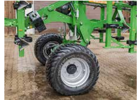
Die Fahrwerkszylinder dürften den Grubber am Vorgewende gerne schneller ausheben.
