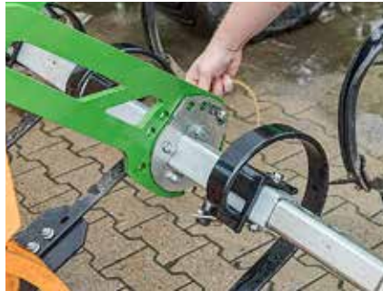
Die Nivellierwerkzeuge lassen sich einfach je Halbseite per Bolzen verdrehen.
