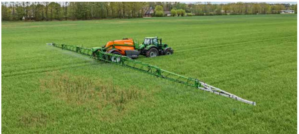
**Mittels DirectInject und der Verwendung von Applikationskarten lassen sich Unkrautnester individuell und präzise in der Fläche behandeln.**
