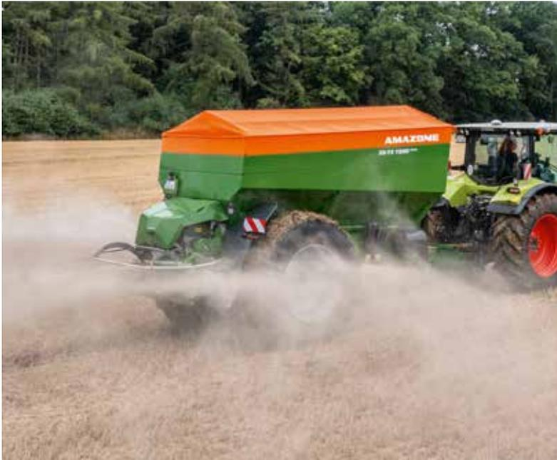
**ZG-TX 11200 Super: Schlagkräftiger Kalkeinsatz mit 17 t Nutzlast und bis zu 16 m Arbeitsbreite**
