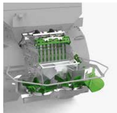
Für den Umbau vom Düngereinsatz (links) zum schlagkräftigen Kalkeinsatz (rechts) sind nur wenige Bauteile zu wechseln.
