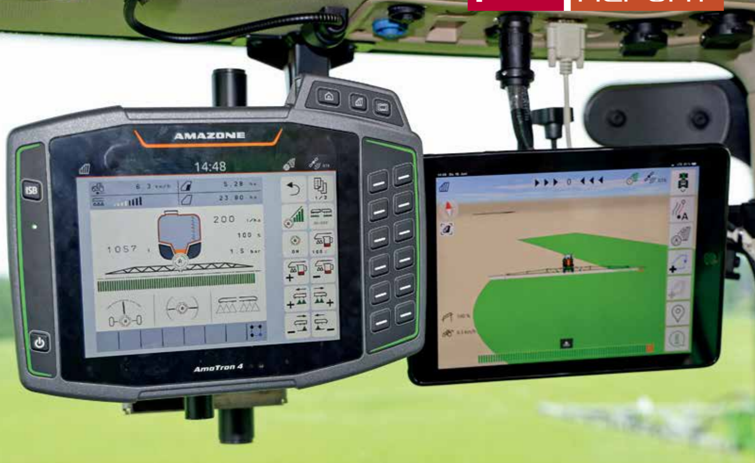
Программа AmaTron Twin-App устанавливается на iPad (справа) и отображает вид поля, а ISOBUS-терминал AmaTron 4 – режимы работы и настройки опрыскивателя
