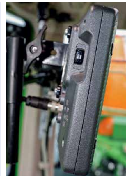
Один из разъемов USB на терминале комплектуется WLAN-адаптером, обеспечивающим соединение
