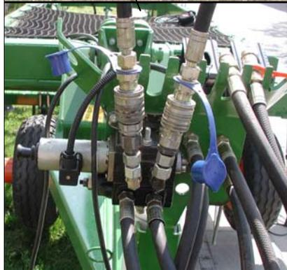
**4-Wege Hydraulik Ventilblock mit elektr. Magnetventil**
