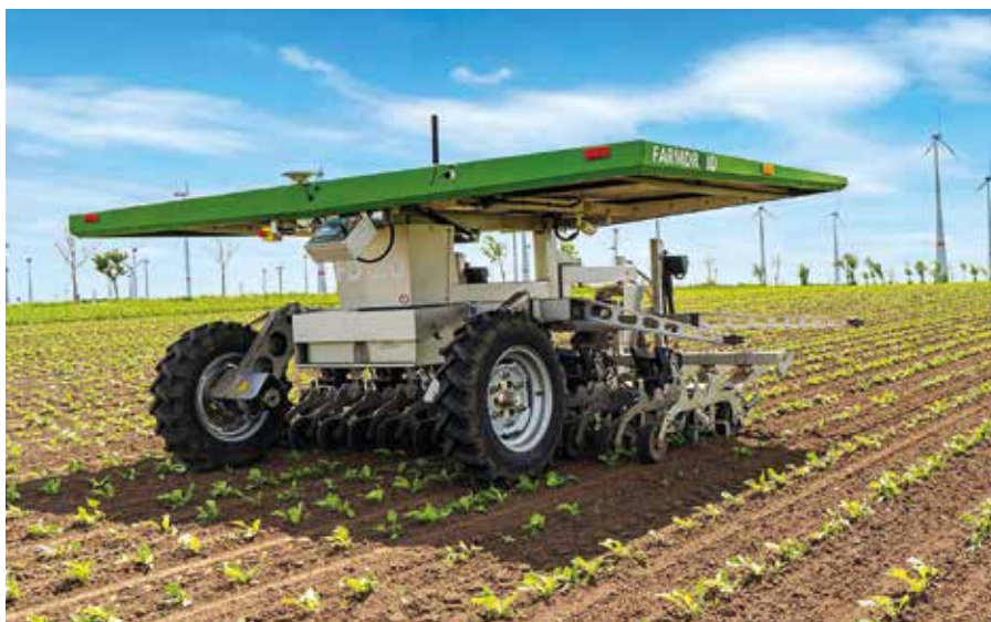
Samojezdny pojazd FarmDroid FD20 zasilany jest energią słoneczną i potrafi precyzyjnie wysiać nasiona, a po zamianie osprzętu wykonać pielenie.
